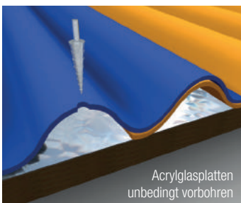
Querschnitt: Befestigung vor der Überlappung
